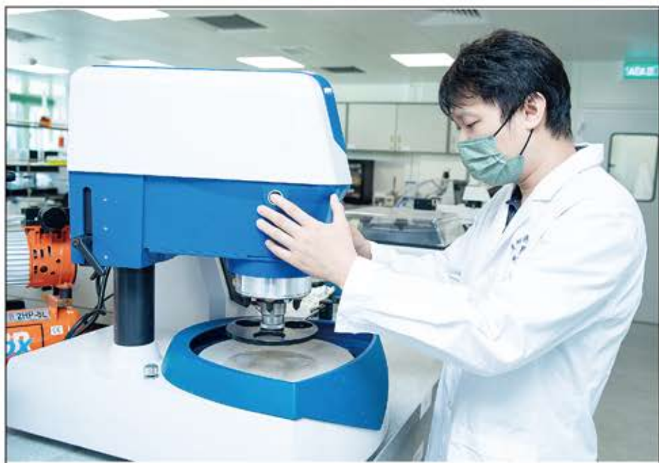
澳門科技大學月球與行星科學國家重點實驗室助理教授鄧志培在實驗室使用機械拋光機。
